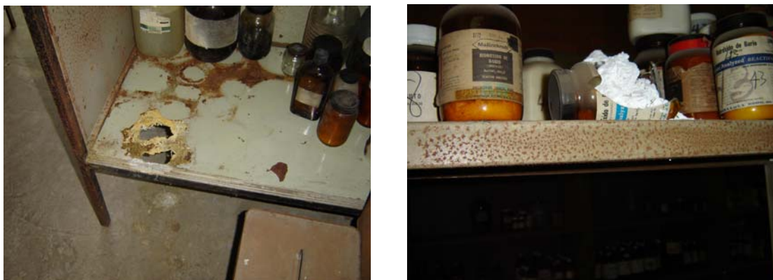
Foto 6a y 6b. Corrosión de anaqueles y explosiones sin motivo aparente
