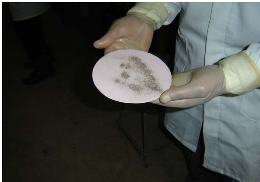
Foto 11. Frotis para medir el grado y radio de contaminación en el entorno.
