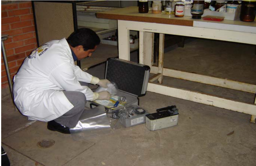
Foto 8. Personal de la Comisión Nacional de Seguridad Nuclear y Salvaguardas, preparando y calibrando el equipo para realizar la medición de la radiactividad en el almacén de sustancias químicas.
