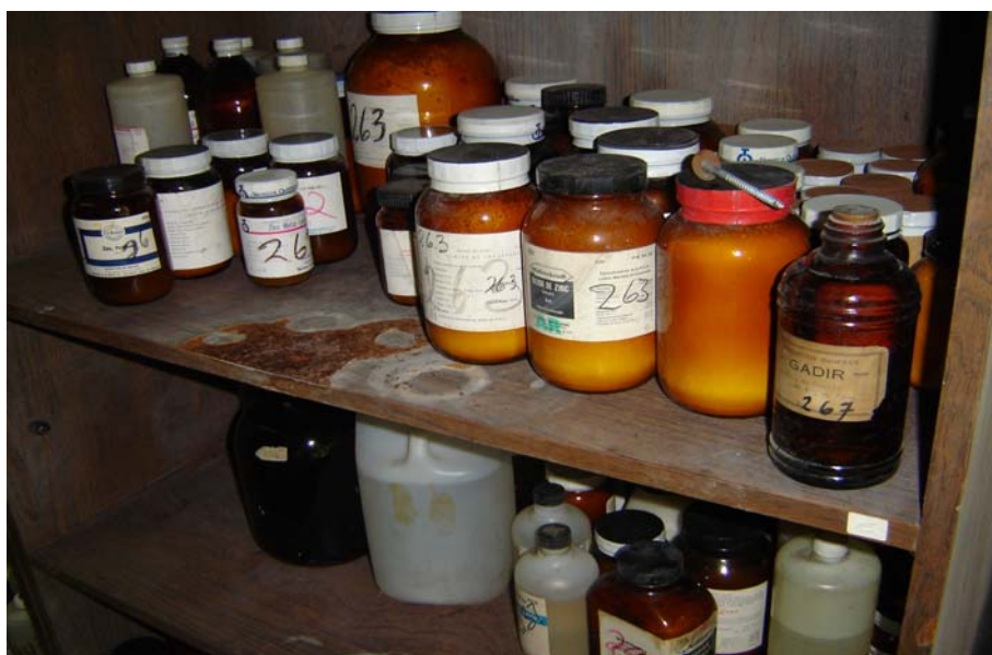
Foto 7. Presencia de sustancias radiactivas sin el debido embalaje, generando contaminación en un amplio radio y corrosión en muebles de formica.
