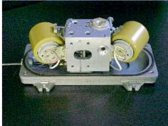
Fig 2.6 Sismómetro Electromagnético ruso tipo Galizin
