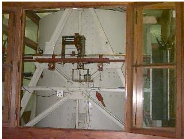
Fig 2.4 Sismógrafo horizontal Wiechert de 17,000 kilos 1910
