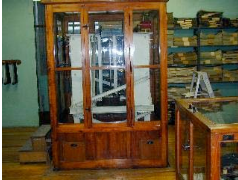
Fig 2.5 Sismógrafos Verticales Wiechert de 1300 kilos 1910
