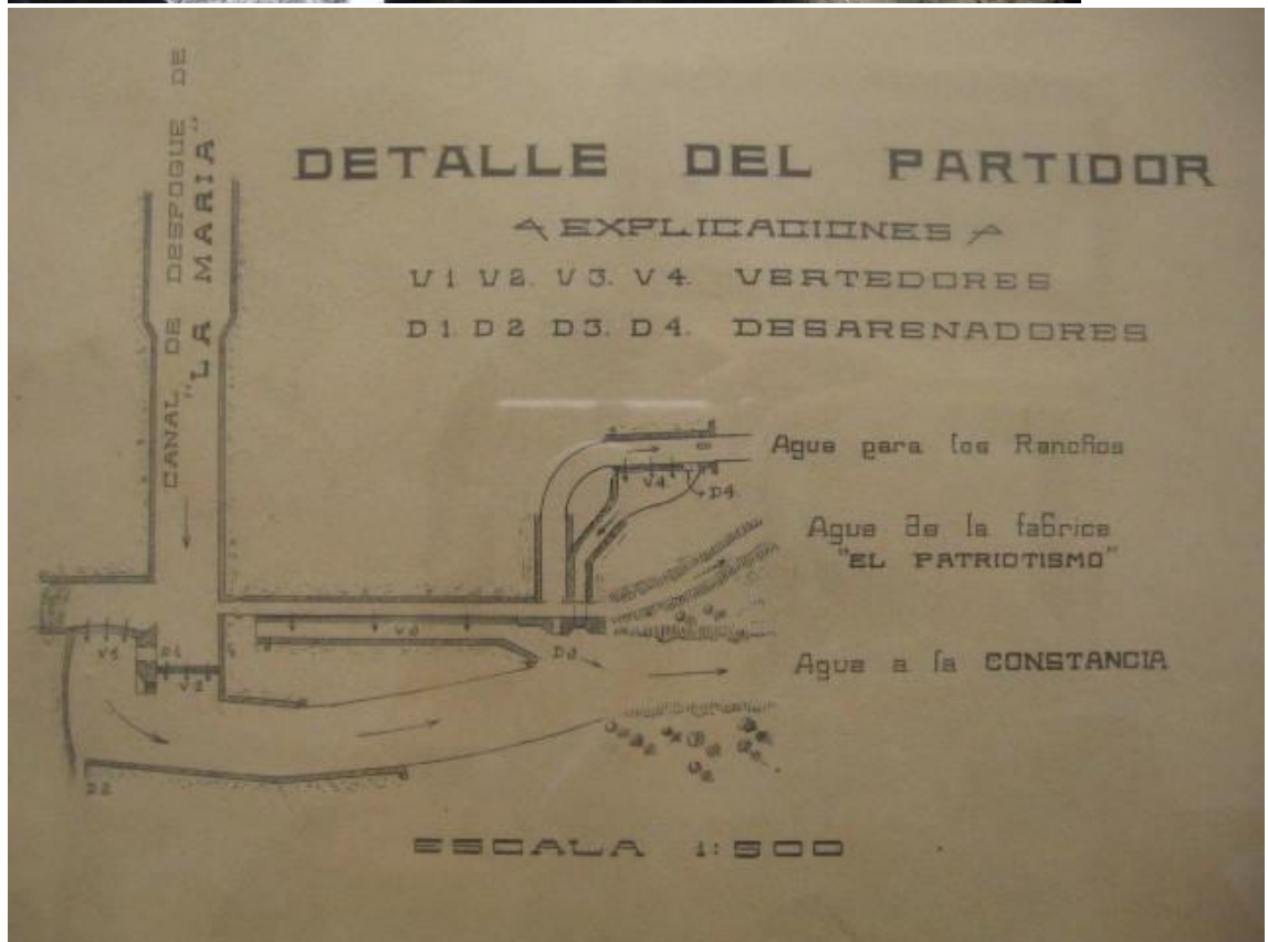
Presas en el río Atoyac para llevar agua a La Constanica Mexicana y partidor
