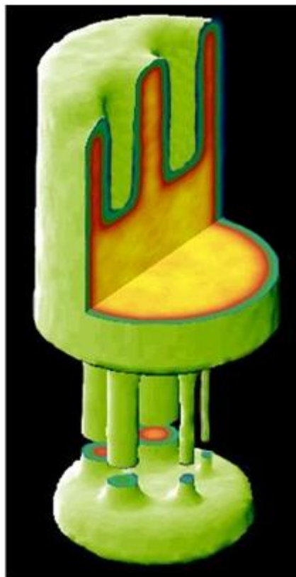
Figura 5.13 Representación tridimensional de la distribución de actividad dentro del maniquí tipo NEMA.
