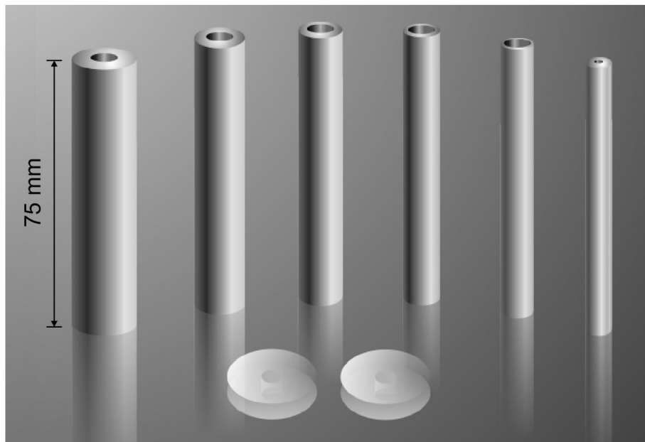
Figura 4.3 Maniquí compuesto de diferentes tubos de aluminio utilizados para medir la sensibilidad de la cámara.
