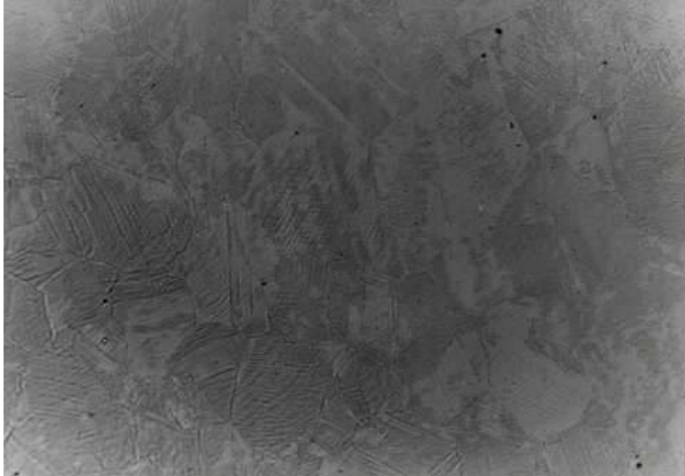
Figura 6.7 Acero 316L implantada con iones de oro de 9 MeV; en esta foto se observa claramente el revelado de la estructura del acero a causa del espurreo. Imagen obtenida con microscopio óptico a 200x en campo claro.
